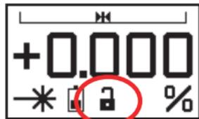
For at låse vinkelposition, holdes STJERNE-knappen inde, derefter trykkes på en OP eller NED pileknop (a) for at låse vinklen til den aktuelle værdi.
